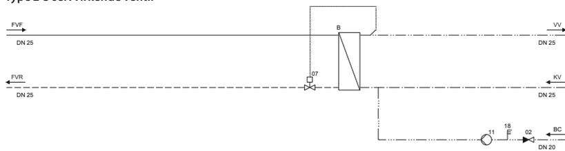
**Type 4-8 med selvvirke ventiler/kaskade**
